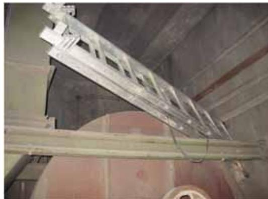
Die Bereitstellung einer Leiter war für Arbeiten mit hohem manuellen Kräfteinsatz und möglichem Gleichgewichtsverlust ungeeignet. Es fehlte für die Arbeiten in der Höhe eine Absturzsicherung. Unfallbegünstigend wirkte sich aus, dass für die
