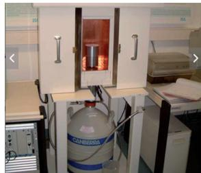
Radioaktivitäts-Spurenmessplatz mit Bleiabschirmung<sup>1</sup>
