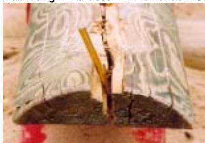
Abbildung 3: Holztier mit splitterndem Holz und Fangstelle für Finger
