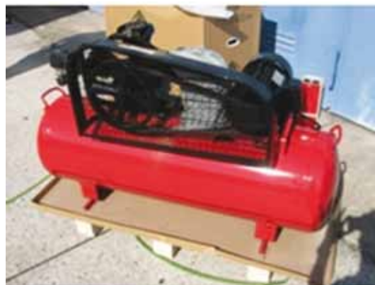
Abbildung 32: Kompressor mit Druckbehälter
