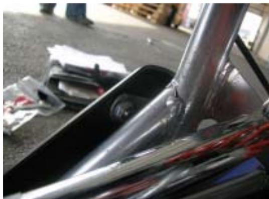
Bremsbacke der Hinterradbremse im Montagezustand nicht über der Bremsscheibe saß (Abb. 49). Der Bremsbelag konnte daher nicht in seiner gesamten Fläche wirksam werden. Zusätzlich wurde durch einen Konstruktionsfehler beim Nachspannen der Kette die Bremsscheibe aus dem Sitz des Sattels herausgezogen. Dies führte dazu, dass die Bremse unwirksam wurde (Abb. 50).
