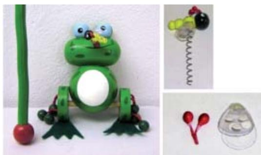
Abbildung 45: Spielzeug mit Gefährdungen nach der Zugprüfung
