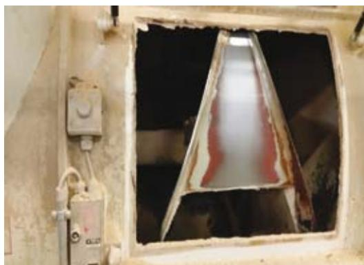
Entgegen der Arbeitsanweisung des Arbeitgebers setzte er den Mischer während der Störungssuche nicht über den elektrischen Betriebsschalter außer Betrieb und sicherte diesen nicht gegen Wiedereinschalten.
