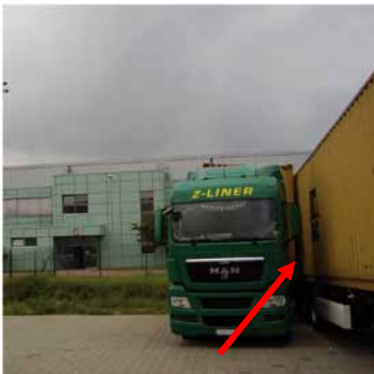
Abbildung 37: Die Quetschstelle von vorn
