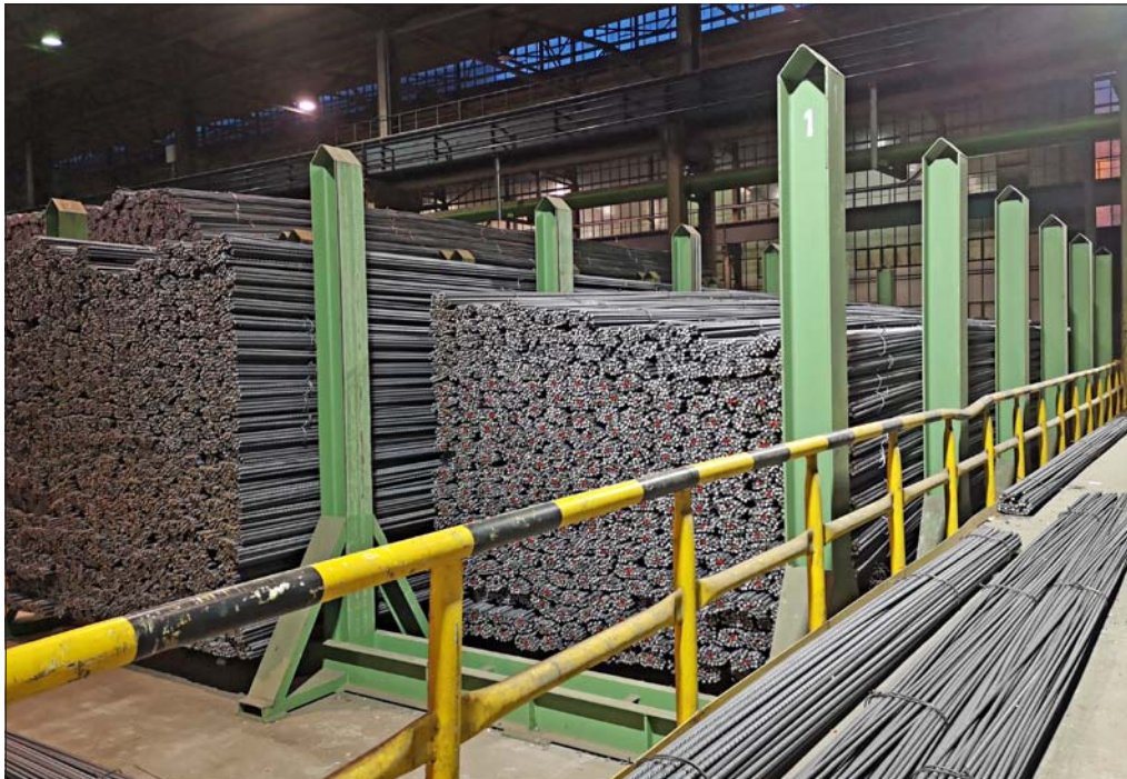
Vorschriftsmäßige Lagerung der Stahlbunde mittels Rungen und einer gegen Absturz gesicherten Grube
