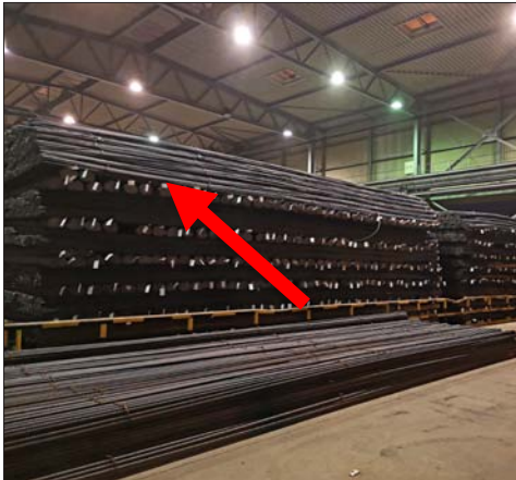
Unzulässige Lagerung der Bunde zu nah an den Randbereichen und in zu vielen Lagen im gesamten Lagerbereich
