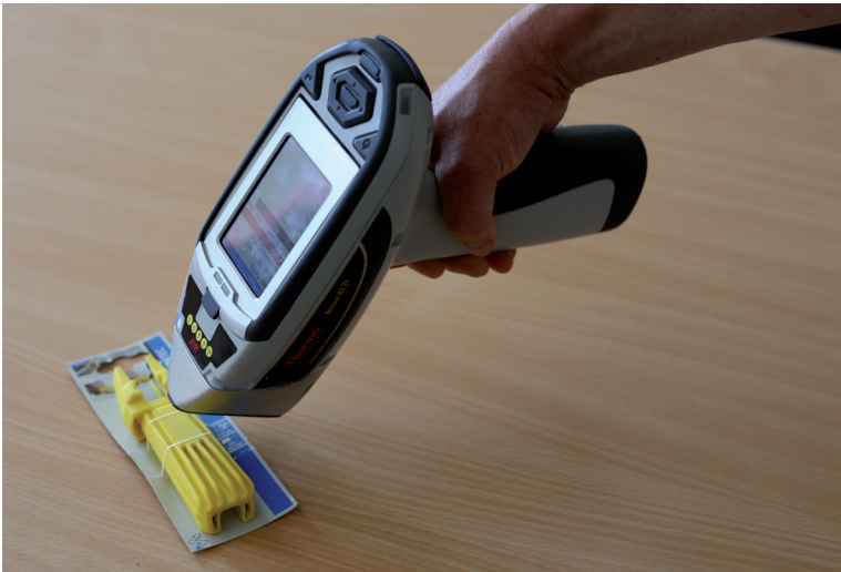
◀ Abbildung 7: Mobiles RFA-Spektrometer © LAVG
