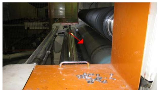
nigung der Walzen mit Lappen und Schwämmen gefahrlos erfolgen kann. Der Anlagenfahrer befolgte die Betriebsanweisung nicht und reinigte die Walzen, ohne den festgelegten Dosierrast einzustellen.
