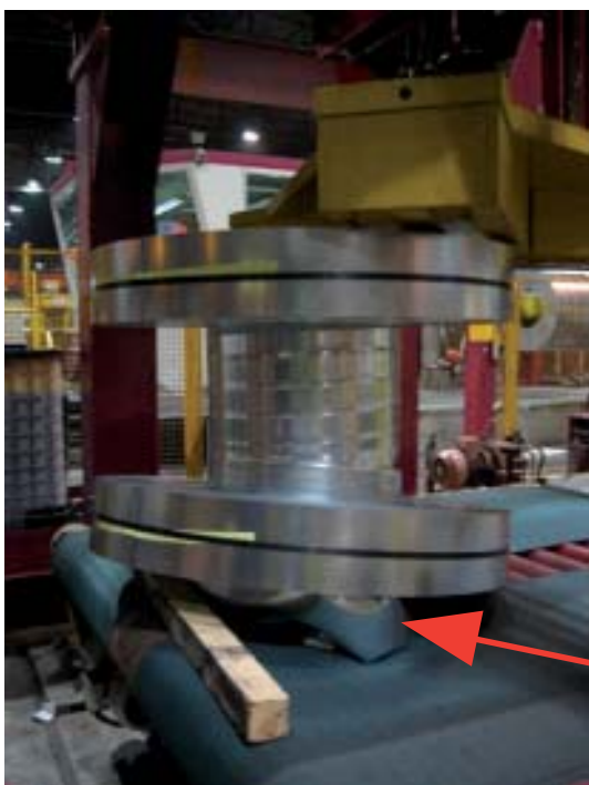
Abbildung 42: Blick von hinten auf den Stapelmagneten (herausgefallener, z. T. aufgewickelter Innenschlag (Kantholz wurde später dorthin gelegt, um den unteren Ring zur Entnahme der Handschuhe aufzuhebeln))
