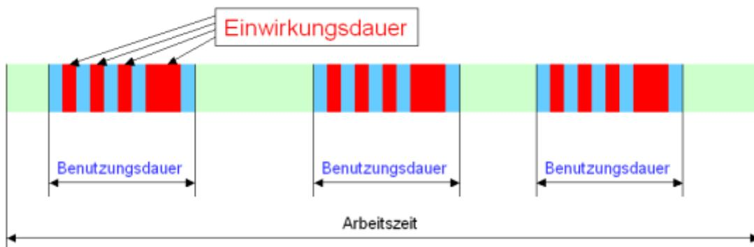
Zur Bestimmung der Einwirkungsdauer gibt es „objektivierende“ Hilfsmittel, sodass diese Erfassung mit hinreichender Genauigkeit auch durch die Unternehmen selbst erfolgen kann. U. U. helfen hierbei Betriebsstunden- und Durchflusszähler weiter. Bei Geräten mit Einzelauslösung kann die Zahl verbrauchter Nägel, Bolzen etc. herangezogen werden. Beim Bohren von Dübellöchern kann die für ein Loch benötigte Zeit mit der Anzahl der gesetzten Dübel multipliziert werden.
