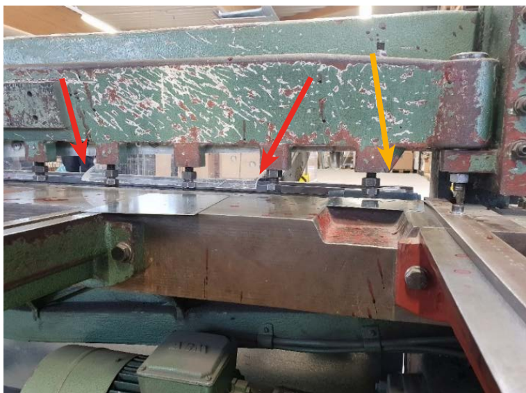
Abb. 16: Gefahrenstelle mit defektem Schnittlinienschutz (rot) und Unfallstelle (gelb)
