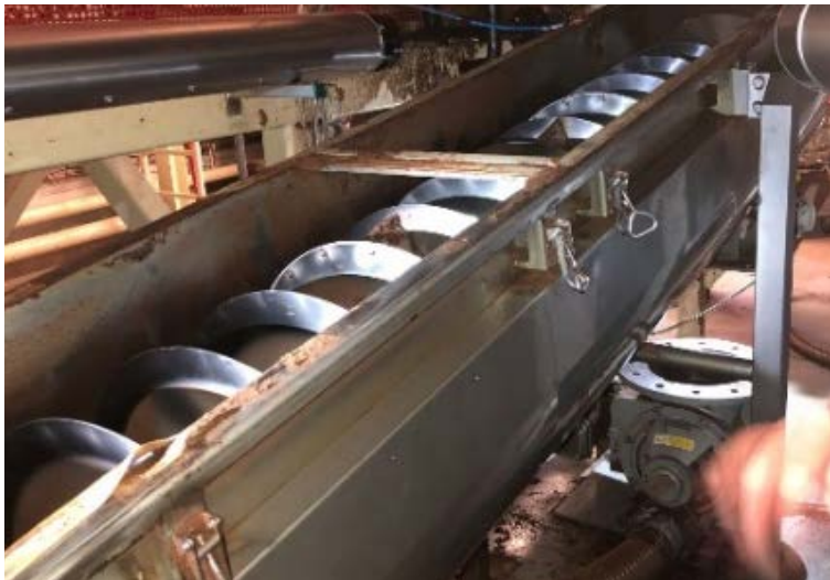
Abb. 17: zugängliche Seite der Transportschnecke mit werkzeuglos zu öffnenden Schnellverspannungen ohne Sicherheitskontaktschalter; die Abdeckung ist entfernt
