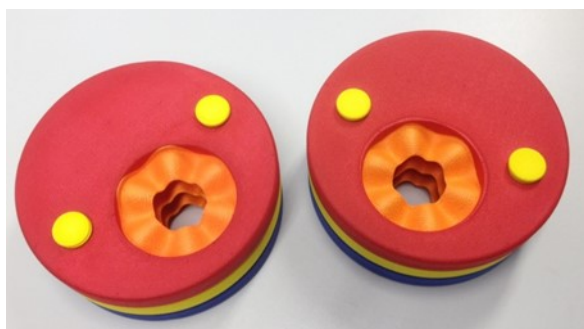
Abbildung 26: am Probemuster fehlen alle erforderlichen Kennzeichnungen
