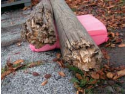
Abbildung 52: Bruchstelle mit umlaufender, tiefer Fäulnis
