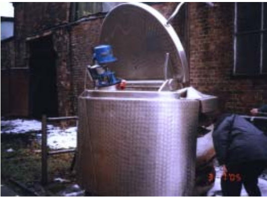
Abbildungen 59 und 60: Der deformierte Rührbehälter
