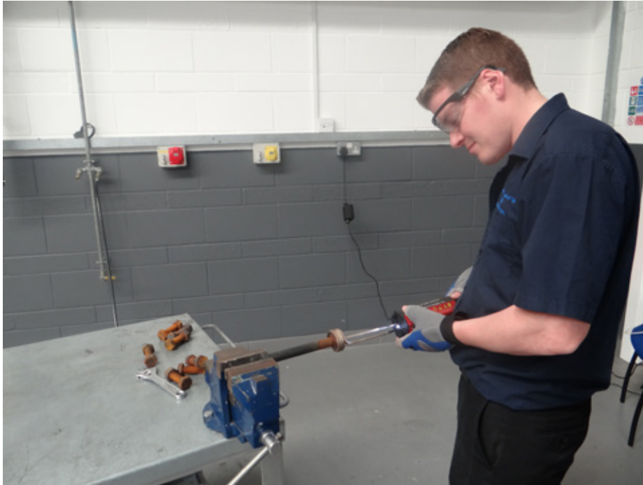
Abbildung 6.3 – Erhitzung eines fixierten Bolzens mit einem tragbaren Induktionserwärmer (Leistung: 1 kW)
