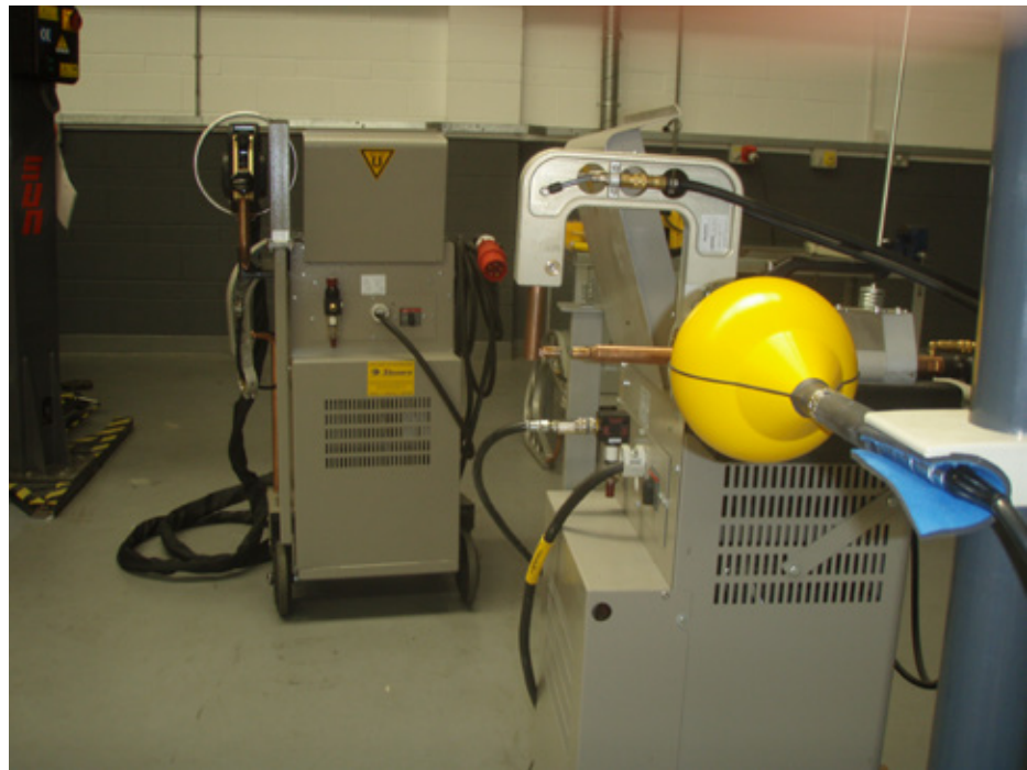
Abbildung 6.7 – Messungen im Umkreis des mit einer C-Zange versehenen Punktschweißgeräts der Reparaturwerkstatt bei befestigtem 160-mm-Arm. Das Schweißgerät mit der X-Zange ist im Hintergrund zu sehen.
