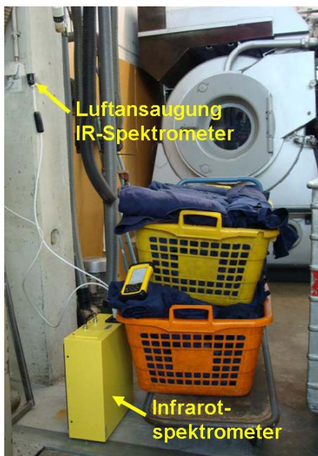
Abb. 6: Messung der PER-Konzentration in der Luft im Arbeitsbereich des Reinigungsanlagenbedieners mit dem tragbaren Infrarotspektrometer
