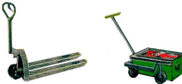
Abb. 11 Von Hand geführte und durch eine Deichsel lenkbare Wagen
