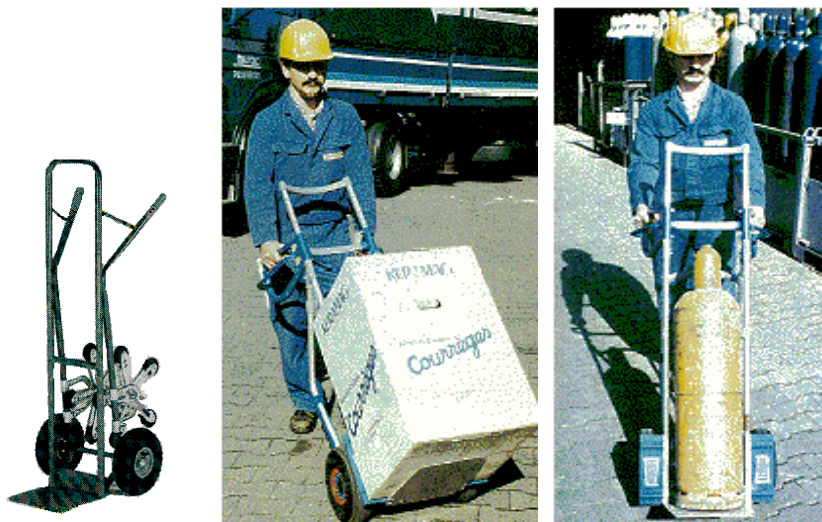
Abb. 6 Stechkarren, wie sie sich zur Überwindung von Absätzen oder Stufen (links) für den Transport über ebene Flächen (rechts) eignen
