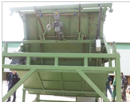
Abbildung 26: Großkistendrehgerät zur Entleerung von Kartoffel-Kisten
