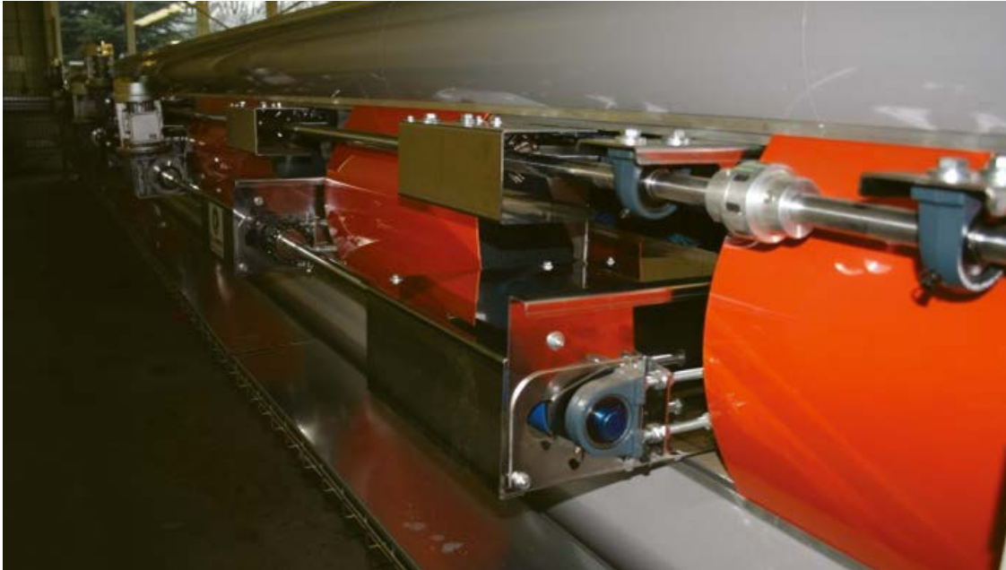
Abbildung 31: unverkleidete Antriebswellen an der Apfelsortiermaschine Grantorino
