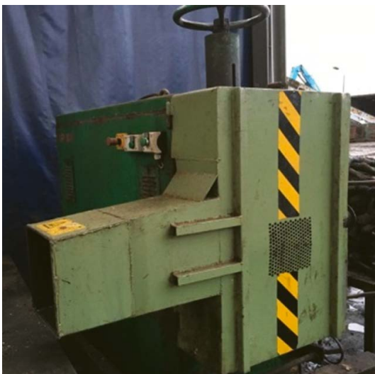
Abbildung 28: Verlängerte wirksame Schutzeinrichtung
