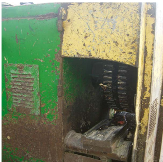
Abbildung 28: Verlängerte wirksame Schutzeinrichtung
