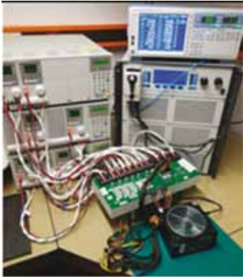
Abbildung 39: Messung der Energieeffizienz eines internen Computernetzteils
