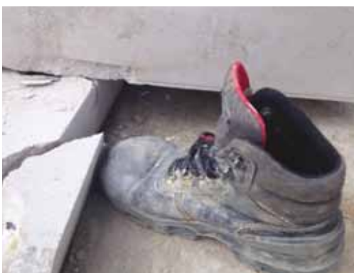
Abbildung 28: Beschädigte Aufnahmeöffnung am KS-Stein
