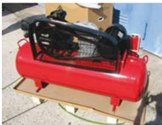
Abbildung 32: Kompressor mit Druckbehälter
