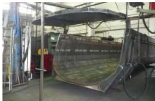
Das Unterstellen von nur einer Stahlstütze, welche unbefestigt auf dem Hallenfußboden stand und an den Verkehrsweg heranragte, garantierte kein sicheres Offenhalten der Muldenklappe bei einer Kollision mit einer Last.
