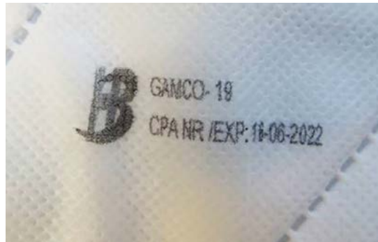
Quelle: Grob Aircraft-SE. Beispiel Kennzeichnung einer CPA-Atemschutzmaske, dies darf aufgrund der unvollständigen Prüfung nicht mit der sonst üblichen CE-Kennzeichnung, dem Kürzel FFP2 oder dem Verweis auf die EN 149 versehen sein
