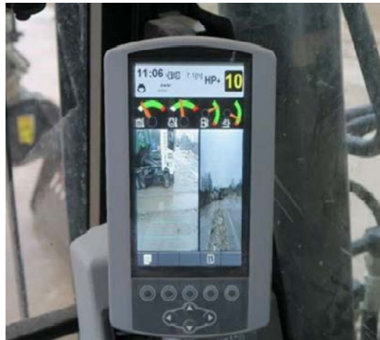
Quelle: Martin Mandel, DEKRA Automobil GmbH. Monitor in der Fahrerkabine des Kettenbaggers mit Darstellung der Sichtfelder der rückwärtigen und seitlichen Kamera
