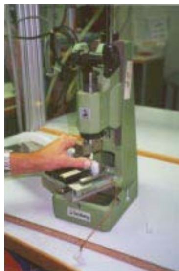
Abbildung 15: Freier Zugriff auf das Trennmesser einer Handpresse
