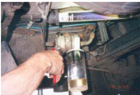
Abbildung 16: Der Wechsel eines Kraftstofffilters mit Hilfe eines Wechselgerätes
