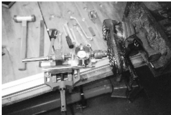
Abbildung 37: Messeinrichtung zur Feststellung der Durchtrittfestigkeit
