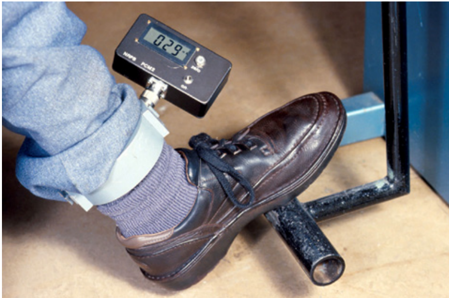
Abbildung C7 Messung des Stroms durch die Gliedmaßen mittels einer Stromzange bei Verwendung eines dielektrischen Schweißgeräts mit 27 MHz
