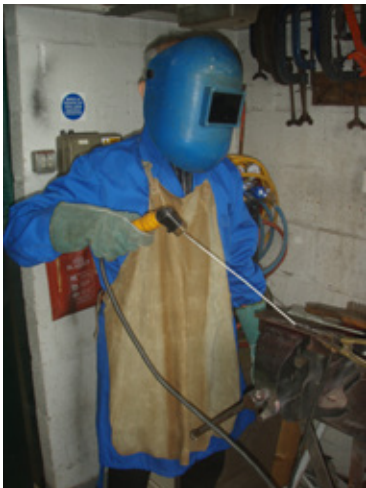
Abbildung 9.11 Beispiele guter und schlechter Praxis bei der Führung des Kabels beim Lichtbogenschweißen
