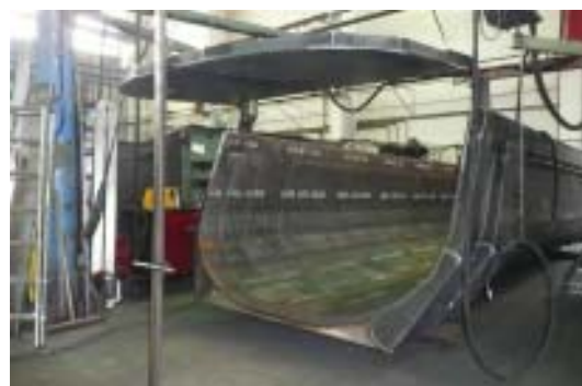
Abbildung 35: Eine offene Muldenklappe
