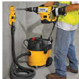
Bild 3 bis 6: Beispiele für abgestimmte Systeme: Kombihammer und Diamantbohrmaschine für das Dosensenken, Bohren und Stemmen mit zusätzlicher Erfassungseinrichtung und einem Entstauber der Staubklasse M
